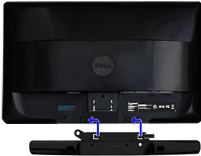
1. Na parte de trás do monitor, fixe o Soundbar alinhando os dois slots com os dois guias ao longo da parte inferior traseira do monitor.
